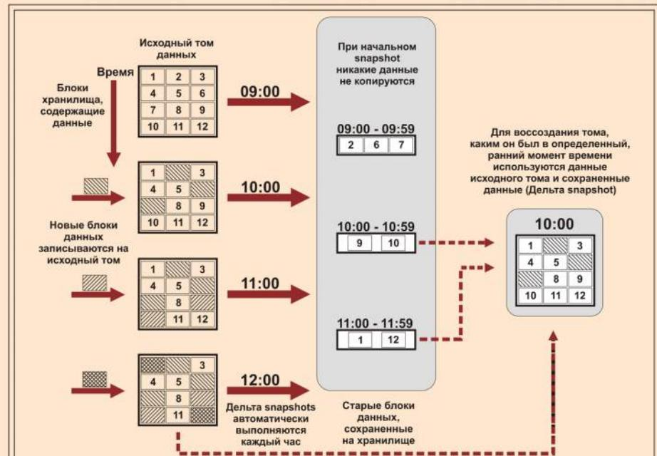
**Organization of snapshots.** В заданное время блоки данных, которые в следующий момент будут модифицированы, записываются в область TimeMark. Таких «моментальных снимков» может быть до 256 на один том. При возникновении сбоя, можно «откатиться» на 256 состояний тома назад, до тех пор, пока полученное состояние не будет соответствовать тому до сбоя или повреждения.
